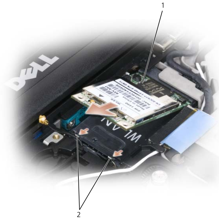
1 ワイヤレス LAN カード 2 金属製固定タブ (2)
