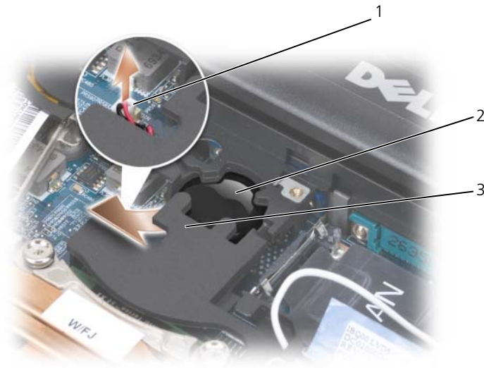
1 バッテリコネクタ 2 コイン型電池 3 透明シート
